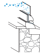
Dans le cas d'un simple vitrage, l'excédent d'humidité est évacué au travers des menuiseries.
