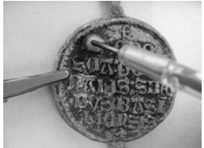
Elektrolytischer Restaurierungsprozess mit Platinanode.
