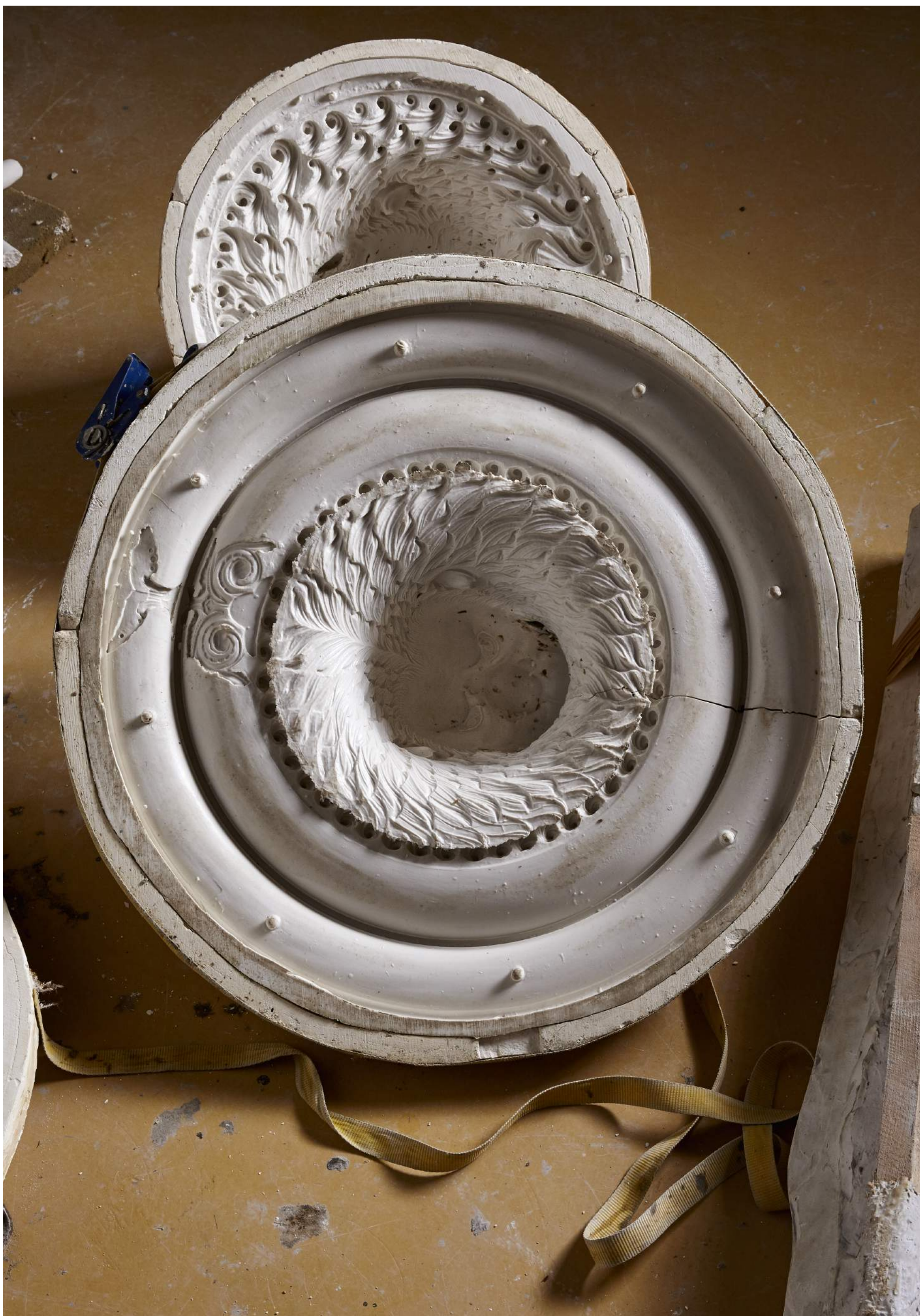
3. MOULE SILICONE NÉGATIF AVEC COQUE EN PLÂTRE
