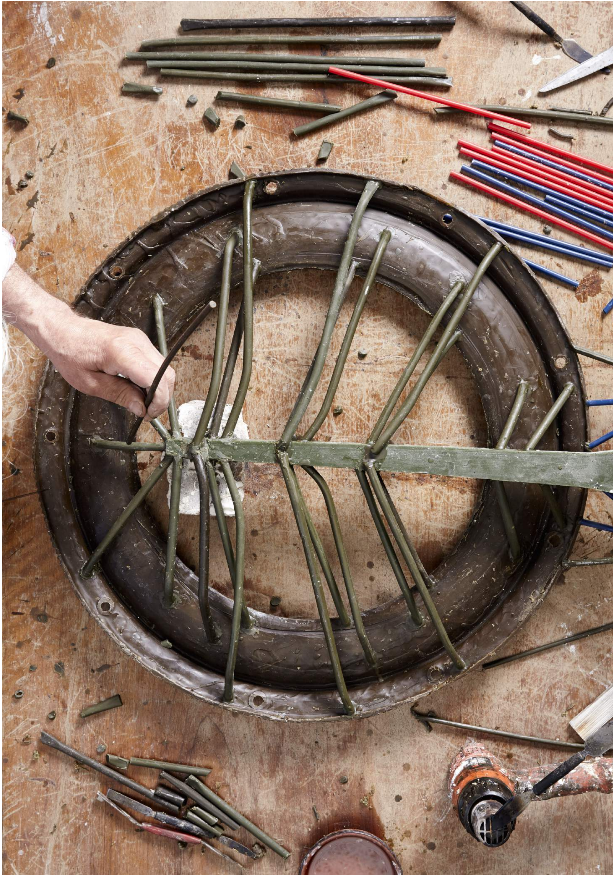
5. POSE DES CANAUX D'ALIMENTATION EN CIRE
