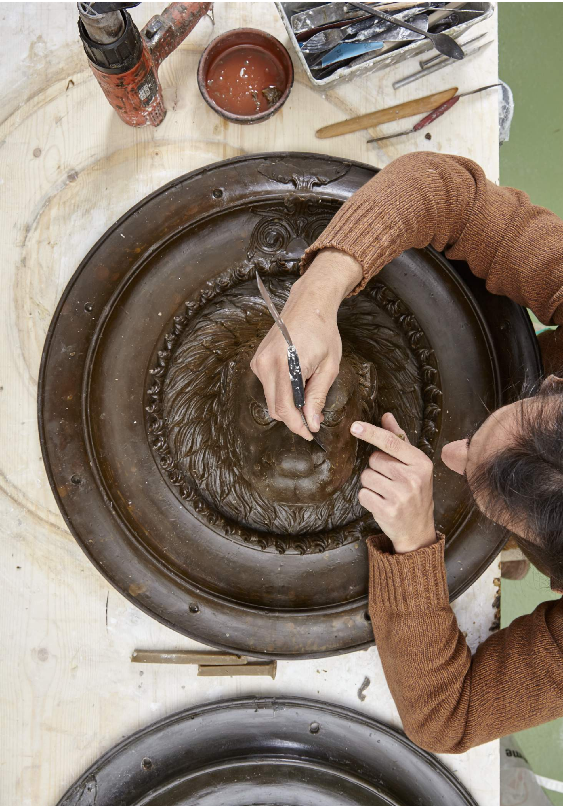
4. RÉALISATION ET CORRECTION D'UN POSITIF EN CIRE
